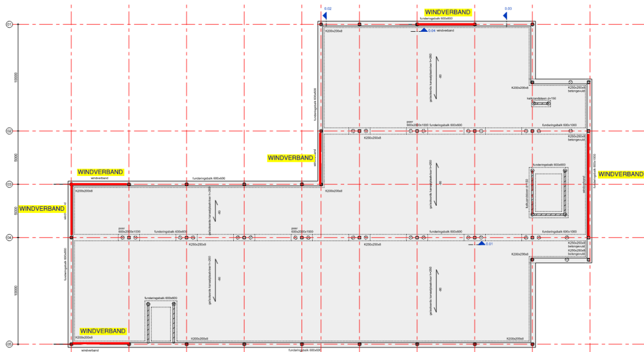
Figuur 6 – Windverbanden begane grond en 1 e verdieping
